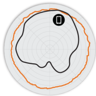
Figura 2. Padrões de antena do azimute T750 2,4 GHz
