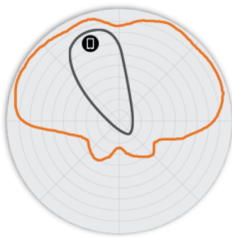
Figura 4. Padrões de antena de elevação T750 2,4 GHz
