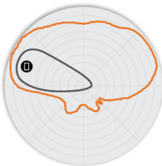
Figura 5. Padrões de antena de elevação T750 5 GHz
