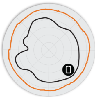
Figura 3. Padrões de antena do azimute T750 5 GHz
