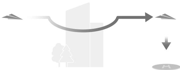
2. **Ideal:** independentemente das configurações de altitude RTH, a aeronave planeja automaticamente a rota RTH ideal e ajusta a altitude de acordo com fatores ambientais, como obstáculos e sinais de transmissão. A rota RTH ideal significa que a aeronave percorrerá a menor distância possível, reduzindo a bateria utilizada e aumentando o tempo de voo.
